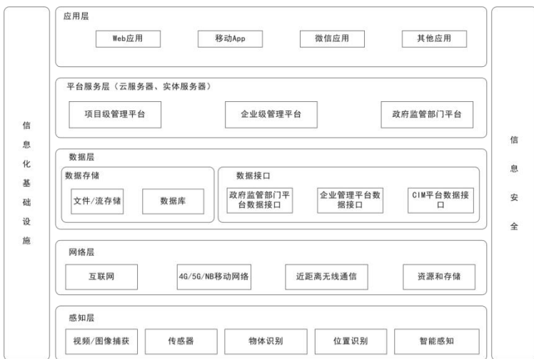
图 1 智慧工地系统架构图
